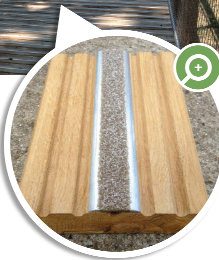
Barrettes antidérapantes RugoPlat® Profilé aluminium anodisé avec résine époxy chargée en corindon
